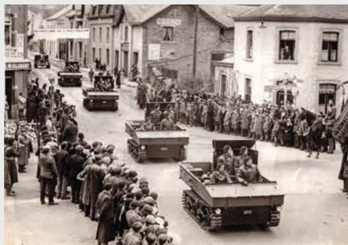
Défilé d'un peloton de canons antichars automoteurs T-13 du 3 ChA à Vielsalm. Ses quatre engins sont suivis d'une chenillette Carden-Lloyd Mk VI équipée de la même pièce FRC de 47 mm que le T-13, mais ce type de véhicule ne figure plus aux inventaires des régiments de Chasseurs Ardennais en mai 1940.
